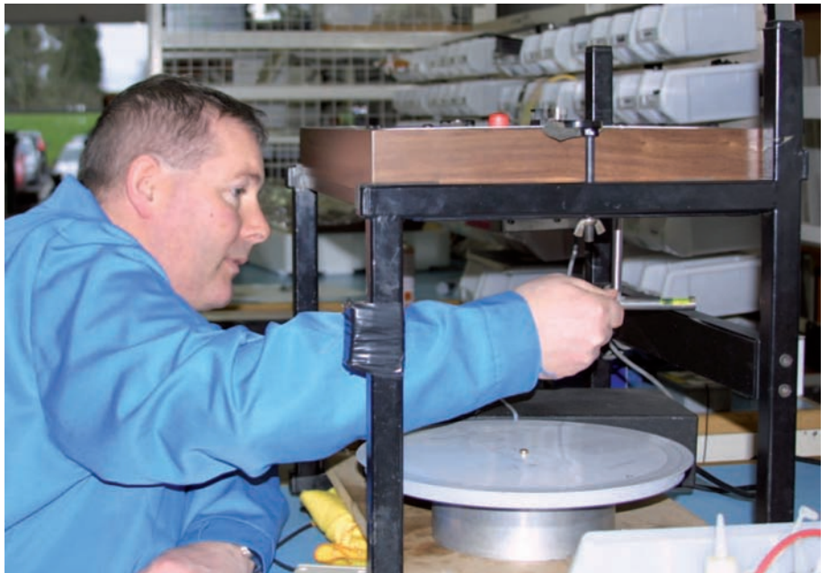
Ein Linn-Techniker aus Glasgow bei der Feinjustage des Subchassis
